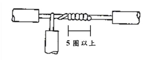
圖一五~五 實心線分歧連接法
