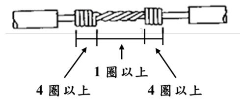
圖一五~二 實心線直接連接法
