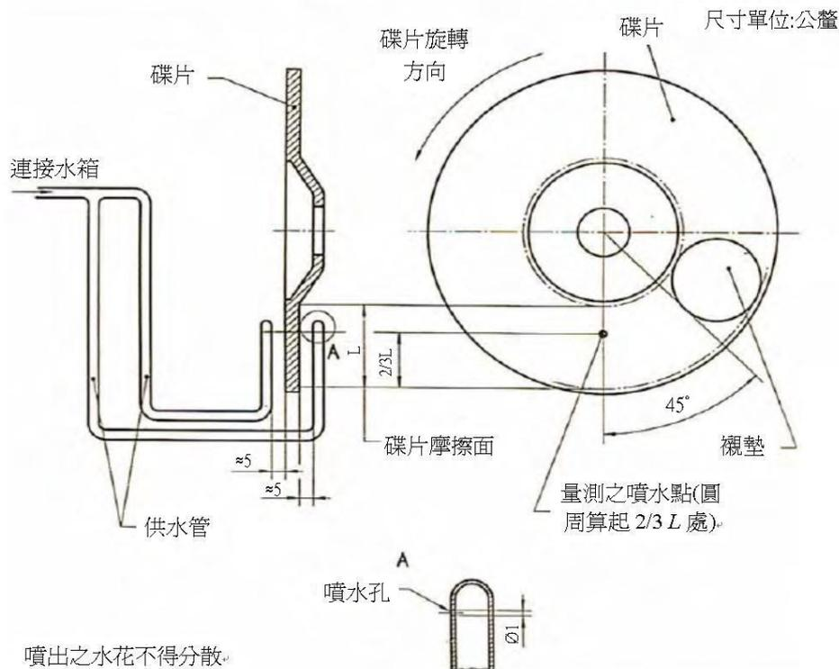
碟式煞車灑水裝置應以下述方式安裝：
